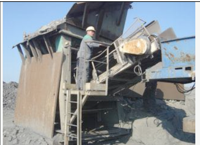
Déboufrage en sortie de crible.
