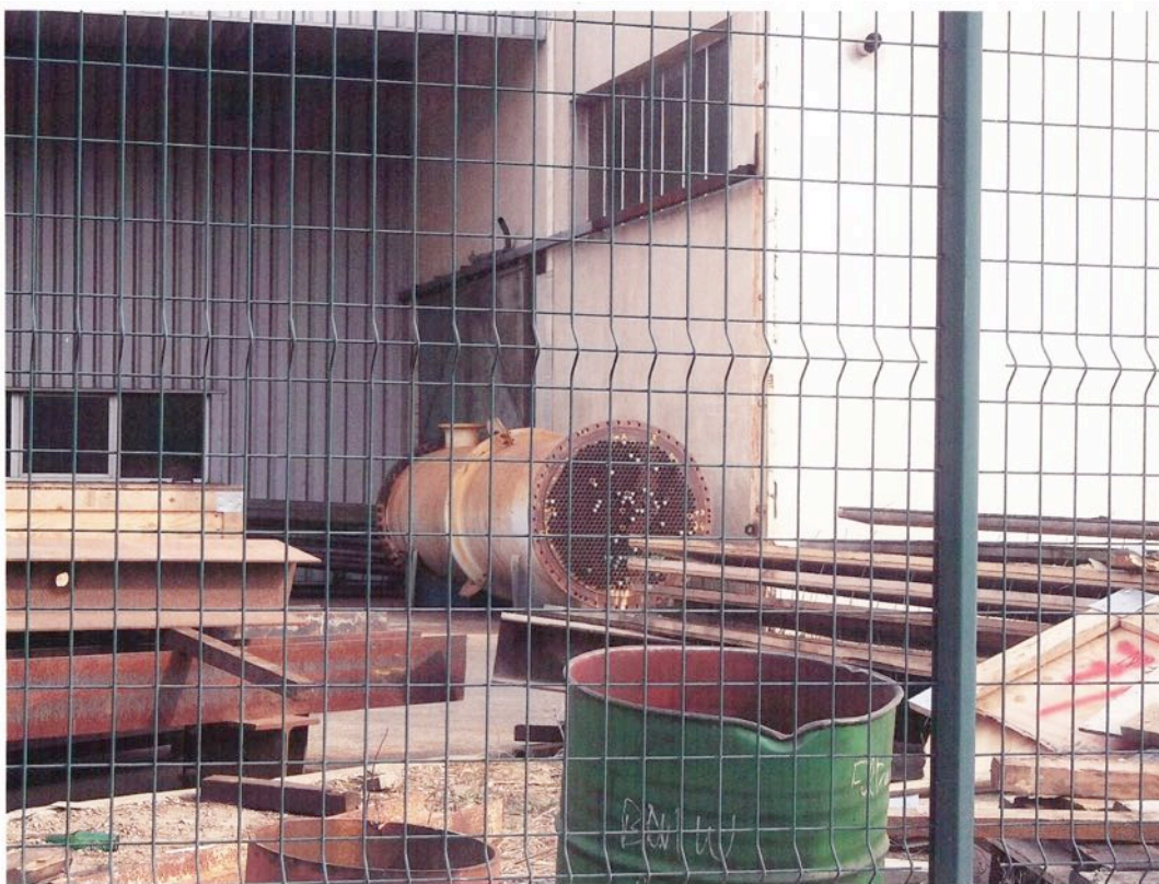
Mars 2012 : un échangeur dans le parc (noter les bouchons obturateurs)
